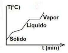
Exemplo: Álcool etílico e água (proporção de 95,5% de etanol e 4,5% de água). Gráfico: O platô (patamar) ocorre apenas na ebulição; na fusão, a temperatura varia.
