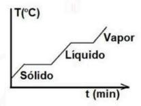
Exemplo: Água pura (funde a 0°C e entra em ebulição a 100°C, a 1 atm). Gráfico: A curva apresenta trechos horizontais (patamares) em fusão e ebulição, indicando temperatura constante nessas mudanças de estado.
